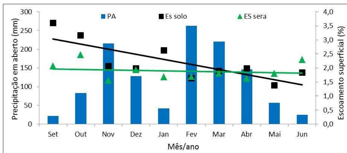
Figura 3. Escoamento superficial (ES) acumulado em % na Mata do Paraíso, Viçosa-MG. Setembro 2012 a junho de 2013.
