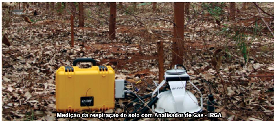
Medição da respiração do solo com Analisador de Gás - IRGA
