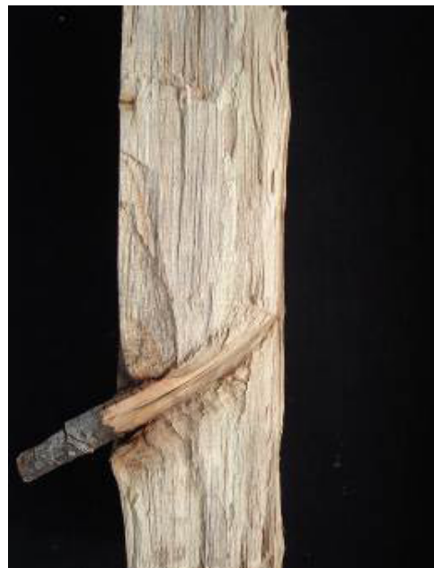
Figura 4. Seção do tronco mostrando o resto do ramo morto como porta de entrada para a podridão do cerne.
