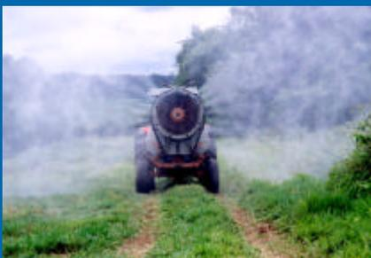
Turbopulverizador em condições normais de campo e aplicando o volume de 2400 L/ha com mistura de bicos de jato cônico vazio e jato cônico cheio
