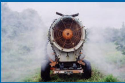
Turbopulverizador ajustado com todos os bicos idênticos de jato cônico vazio e aplicação de 600 L/ha.
