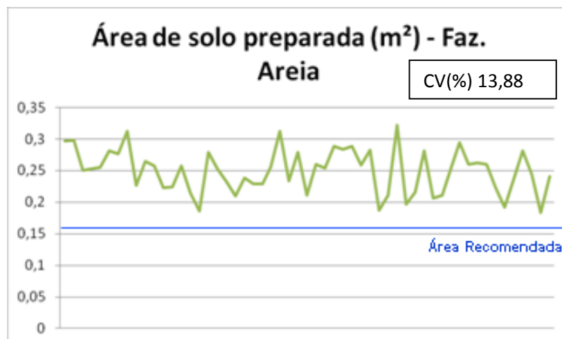
Figura 10 – Área de solo preparada pela haste nova.
