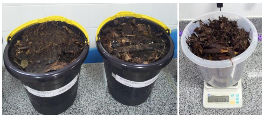
Figura 2 – Saturação das amostras de serrapilheira (A) e obtenção do peso saturado (B), Viçosa-MG, 2013.
