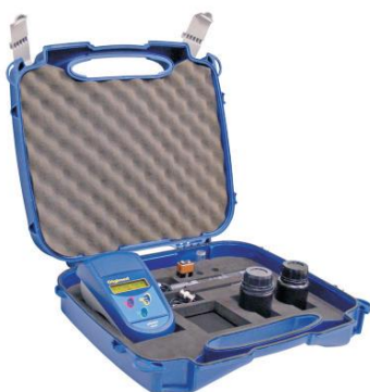
Figura 5 – pHmetro portátil Digimed DM-2P, Viçosa-MG, 2013.
