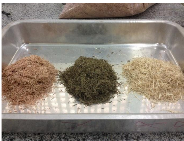
Figura 3 - Eucalipto não tratado, eucalipto tratado com CCB e pinus, respectivamente.
