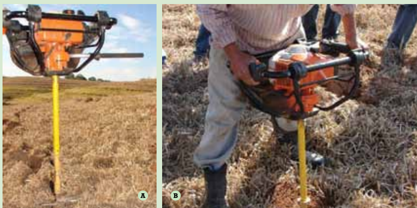
Figura 6.25: Aspecto de uma motocoveadora (A) e abertura de cova com motocoveadora (B).
