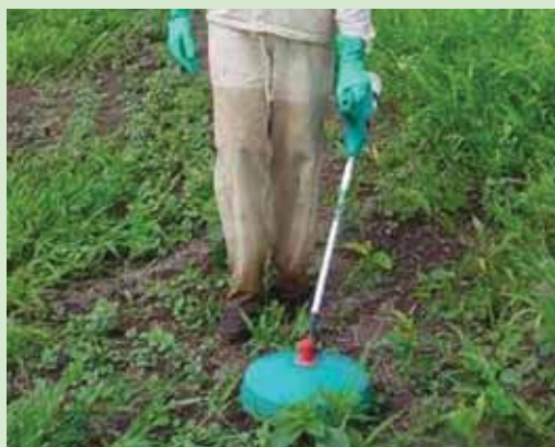
Figura 6.13: Pulverizador de Ultra Baixo Volume que aplica o herbicida puro, dispensando o uso de água.
