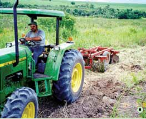
Figura 6.9: Incorporação de resíduos com grade leve e pesada, Reservatório de São Luís em Santa Barbara, SP (A) e Floresta Estadual de Assis, SP (B).
