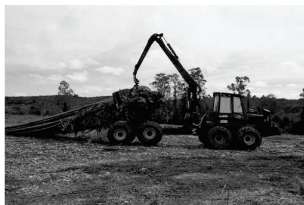
Figura 2 – Extração de madeira de eucalipto com clambunk Skidder, Timberjack, modelo 1710D.
