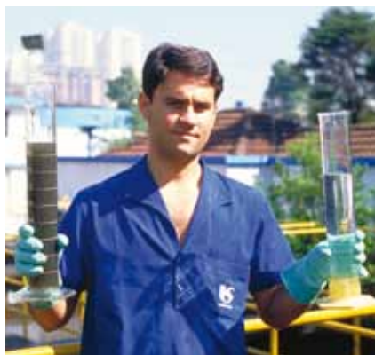
ESGOTO ANTES E APÓS TRATAMENTO. Fonte: Sabesp.
