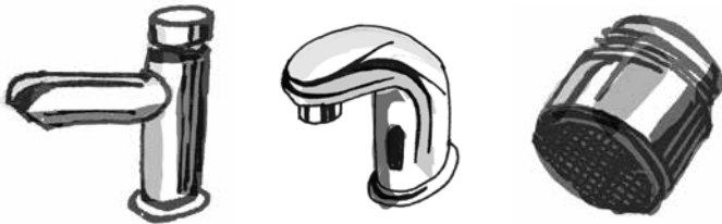
FIGURA 13 – TORNEIRA COM ACIONAMENTO HIDROMECÂNICO, POR SENSOR DE PRESENÇA E AERADOR PARA TORNEIRAS, RESPECTIVAMENTE. (ILUSTRAÇÃO: DIEGOVERNILLE DA SILVA)
