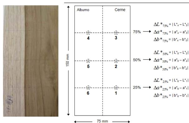
**Figura 2** – Esquema dos pontos de medição das coordenadas L\*, a\* e b\*, antes e depois dos tratamentos termorreificadores, para determinação da uniformidade da cor da madeira de teca.
