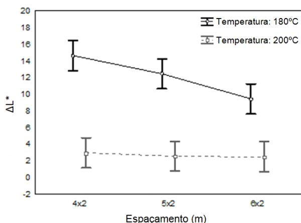
**Figura 3** – Interação entre espaçamento e temperatura para variação da luminosidade ( $\Delta L^*$ ) da madeira de teca após a termorretificação.
