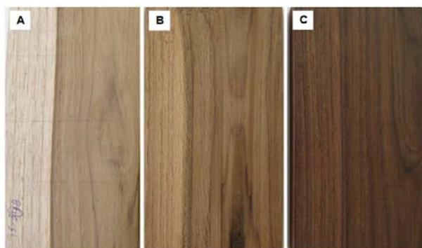
**Figura 4** – Uniformidade da cor da madeira de teca, contendo cerne e alburno após os tratamentos termorreificadores. (A) Madeira original. (B) Madeira termorreificada a 180 °C. (C) Madeira termorreificada a 200 °C.
