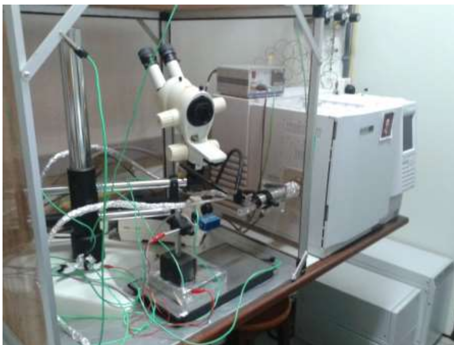
Figura 7. Cromatógrafo de fase gasosa Shimadzu GC-2010 acoplado a um sistema de detecção eletroantenográfica Syntech (Hilversum, Holanda) (CG-EAD). Viçosa-MG, 2012.
