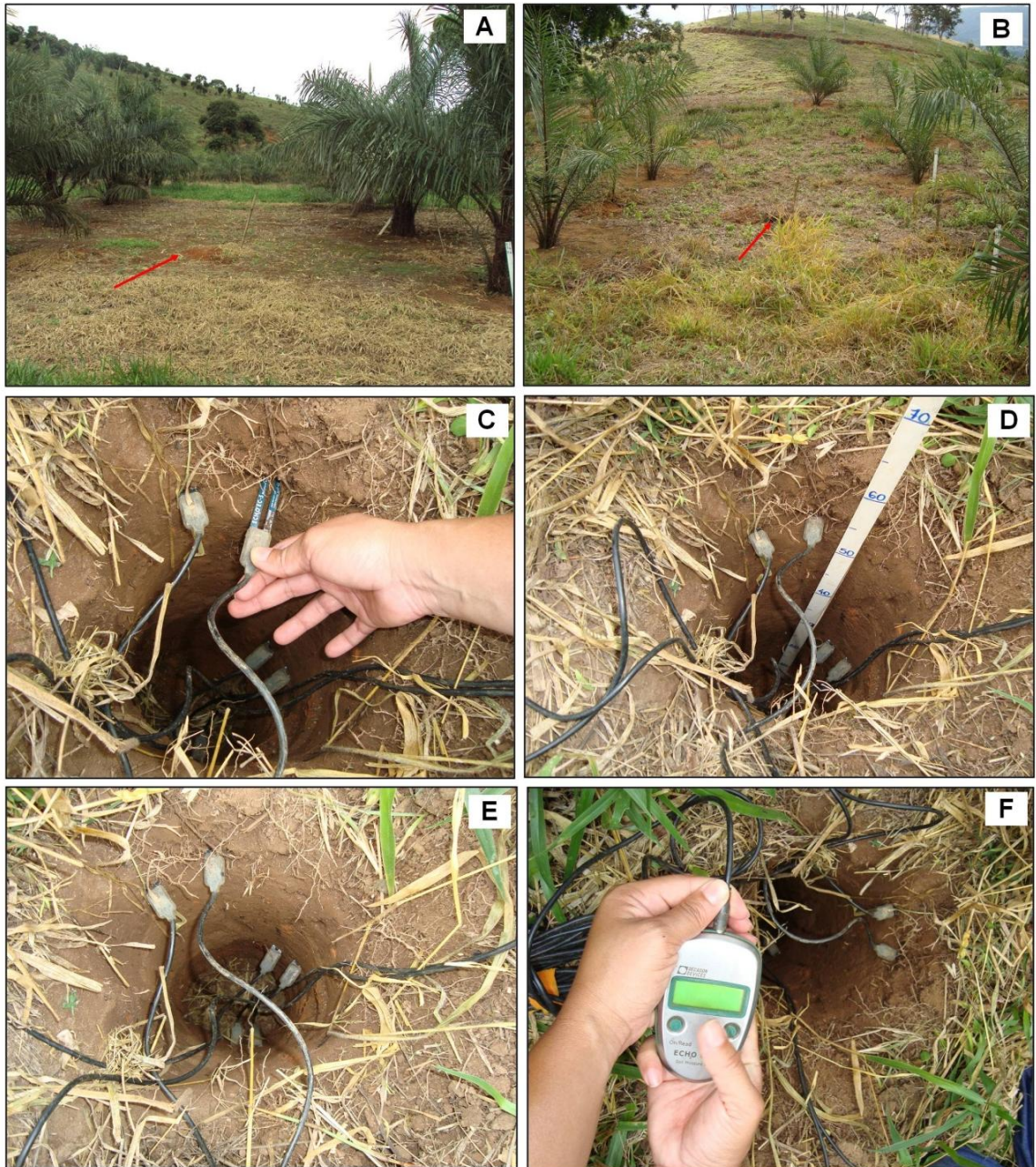
Figura 4. Fotografia das medições de umidade do solo. A - B: Localização da cova no sistema macaúba consorciada com braquiária e sem braquiária, respectivamente (seta vermelha). C - F: processo de introdução do sensor na camada de 0 a 40 cm do solo e leitura.
