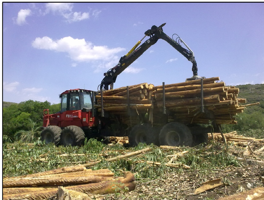
Figura 61 – Trator florestal Forwarder utilizado para a extração da madeira para a margem da estrada.
