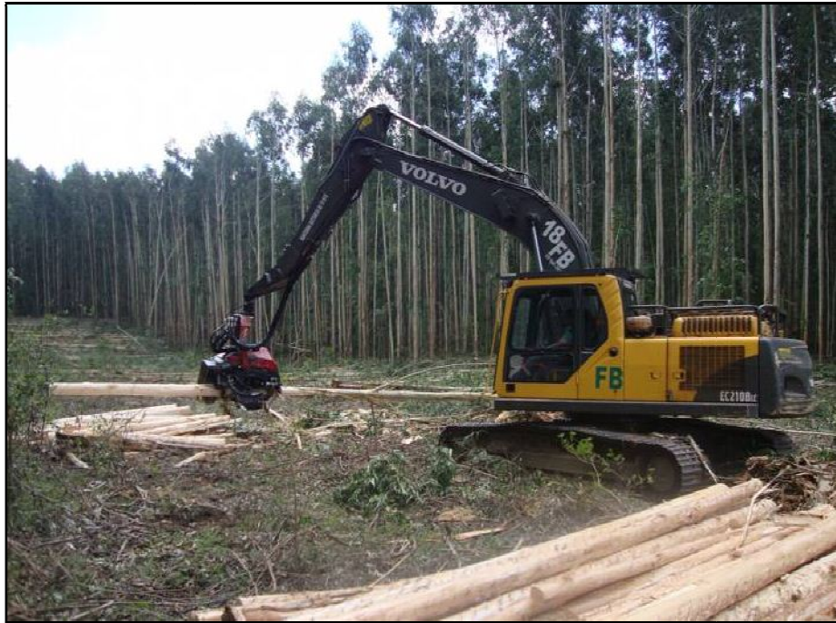
Figura 60 – Trator florestal Harvester utilizado para a derrubada e processamento das árvores.
