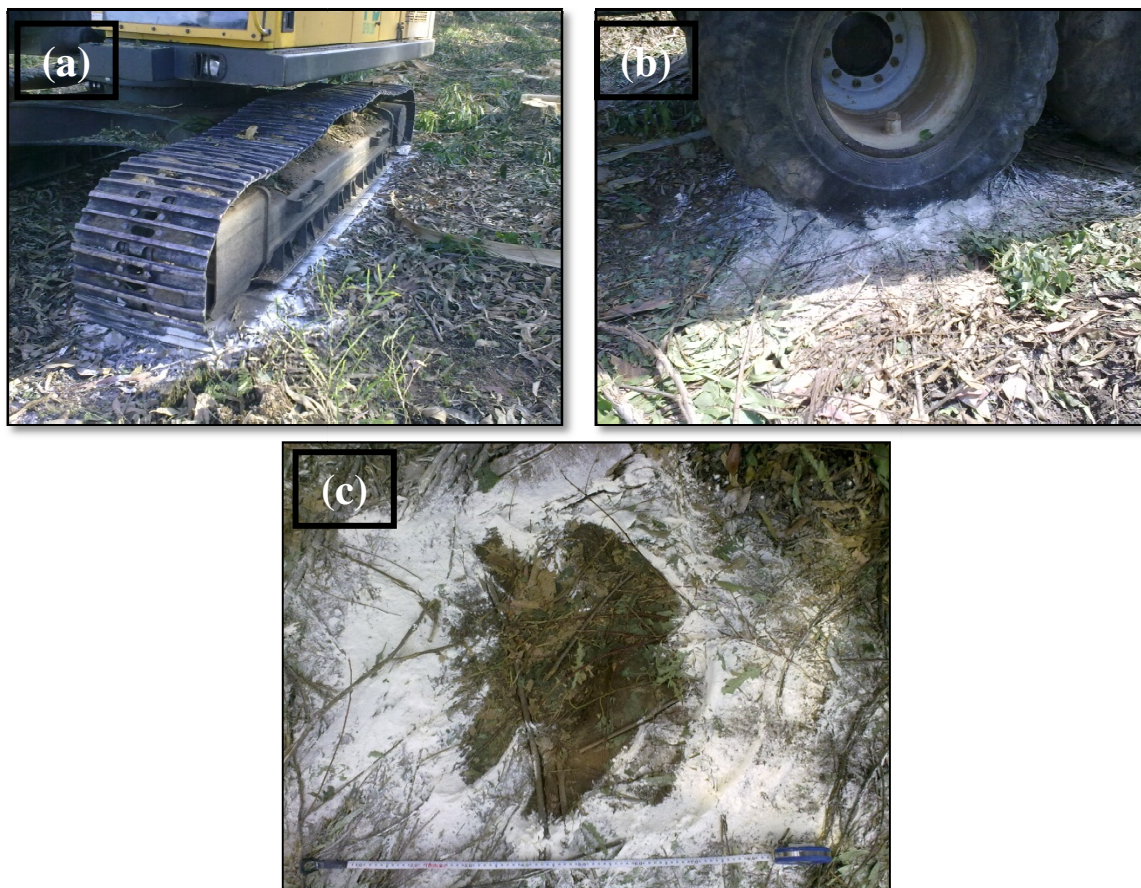
Figura 64 – Determinação de área de contato pneu-solo. Demarcação do rodado do Harvester (a) e do Forwarder (b); foto digital com trena como referência (c).
