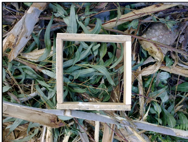
Figura 65 – Moldura quadrada utilizada para determinação da camada de resíduos.
