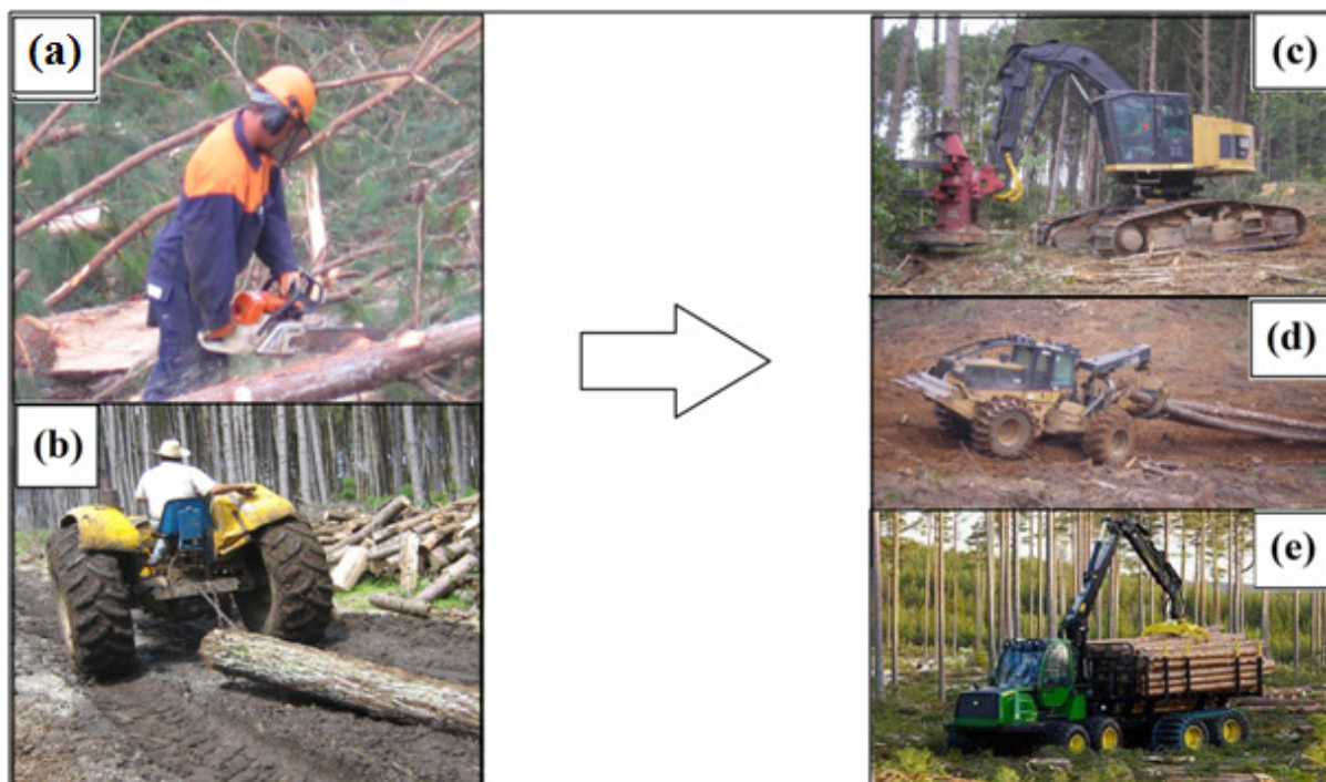
Figura 1 – Evolução da colheita de madeira, partindo do uso de motosserras (a) e tratores agrícolas adaptados (b) para tratores florestais como Feller Bunchers (c), Skidders (d) e Forwarders (e). Fontes: arquivo pessoal, www.deere.com .
