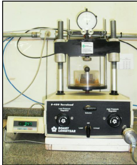
Figura 9 – Consolidômetro utilizado nos ensaios de compressão uniaxial.
