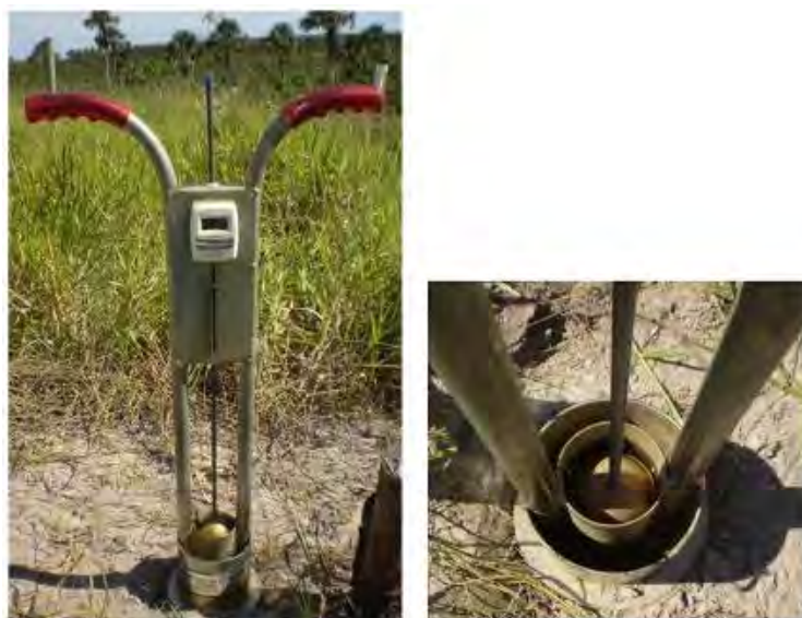
Figura 17 – Infiltrômetro de anéis concêntricos: detalhe os dois anéis e a boia flutuante.
