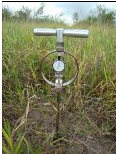
Figura 20 – Penetrômetro de anel Solotestes, modelo Mitutoyo 2046F.
