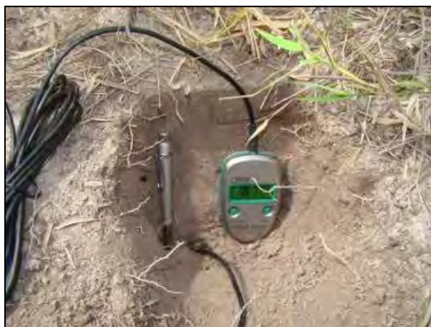
Figura 21 – Equipamento utilizado para mediação de umidade do solo na bacia hidrográfica do córrego Águida, Francisco Dumont, MG, março 2010.
