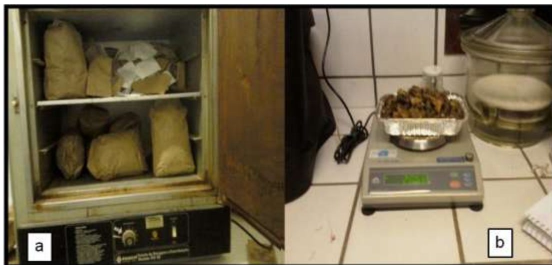
Figura 5. Material na estufa de circulação forçada (a) e depois sendo pesado em balança de precisão (0,01 g) (b).
