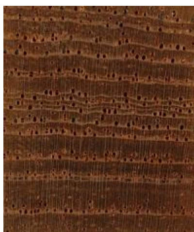
Figura 6 – Fotomacrografia da madeira de cedro – plano transversal, 10X.
