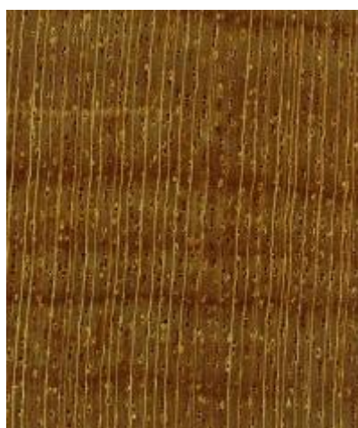
Figura 21 – Fotomicrografia da madeira de pau amarelo – plano transversal, 10X.
