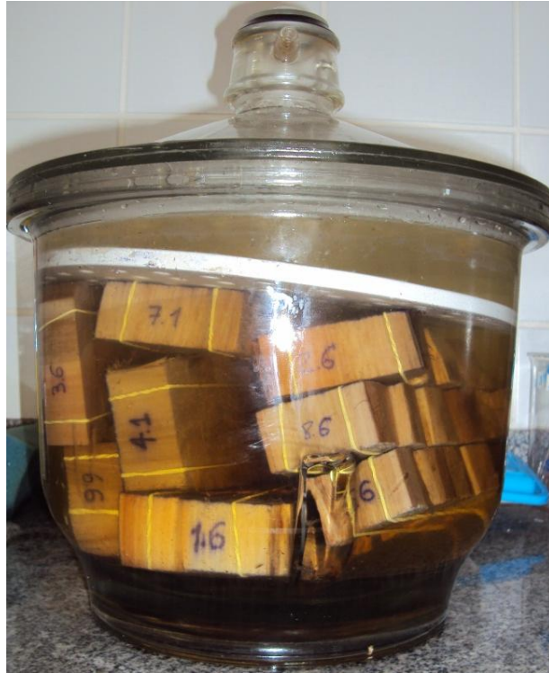
Figura 2 – Baguetas sendo saturadas no dessecador
