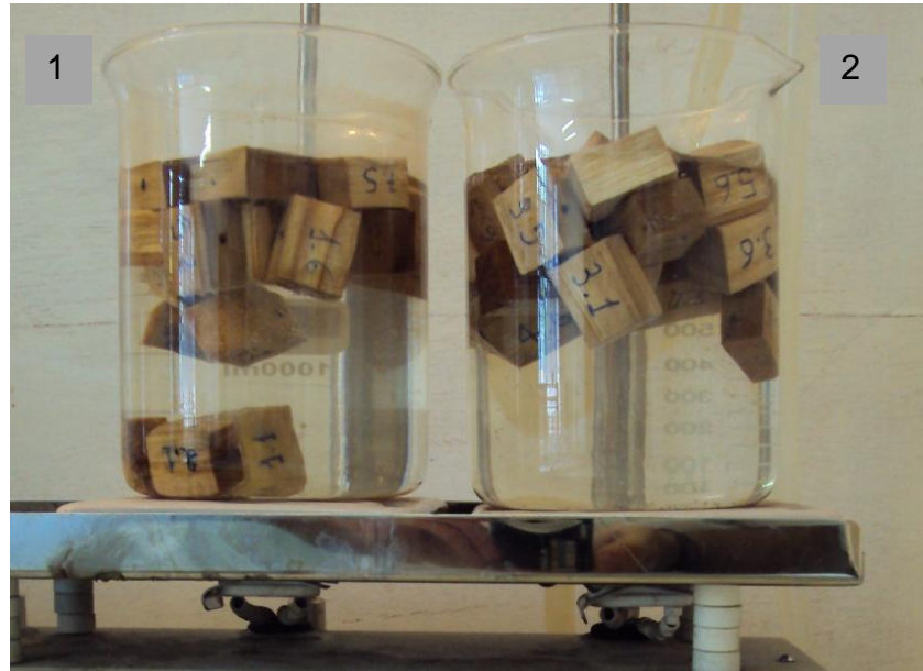
Figura 4 – Procedimento de fervura dos CP's para realizar corte no micrótomo: 1) clone quebrado com o vento (15') e 2) clone não danificado com o vento (30')
