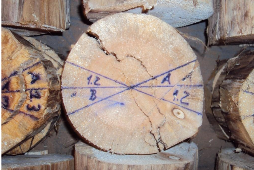
Figura 1 – Disco ilustrando a marcação das cunhas que foram utilizadas para determinação da densidade
