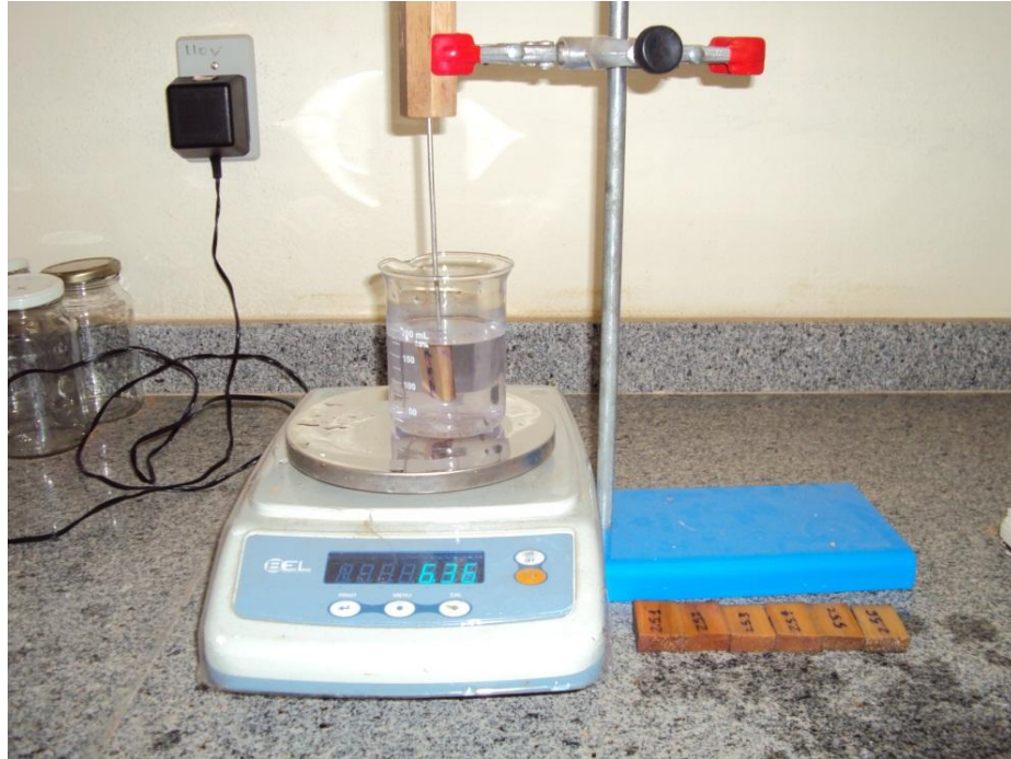
Figura 3 – Procedimento de imersão para determinar o volume
