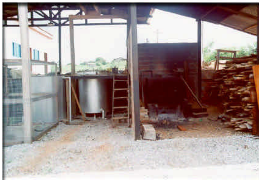
FIG. 1. Destilador de campo para óleo essencial de pimenta longa.
