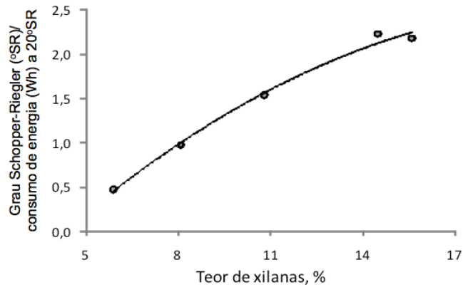
Figura 4. Grau Schopper-Riegler (°SR) /consumo de energia de refino (Wh) a 20 °SR em função do teor de xilanas presente na polpa.
