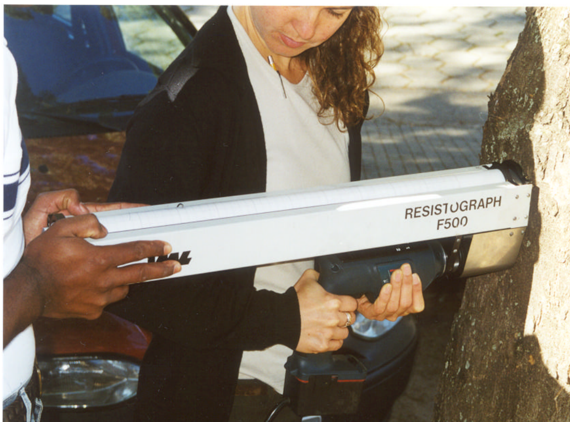
Figura 6 – Teste com o equipamento Resistógrafo®.
