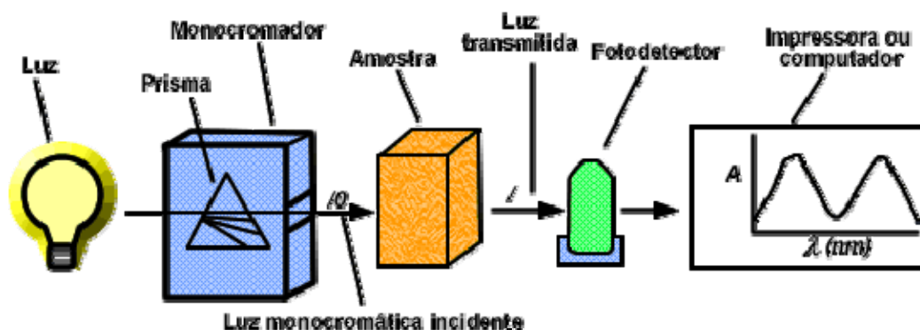
Figura 4 – Diagrama esquemático de espectrômetro
