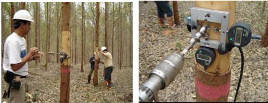
FIGURA 1 Extensômetro usado para a obtenção indireta da tensão longitudinal (DRL) e tangencial (DRT) de crescimento na árvore viva
