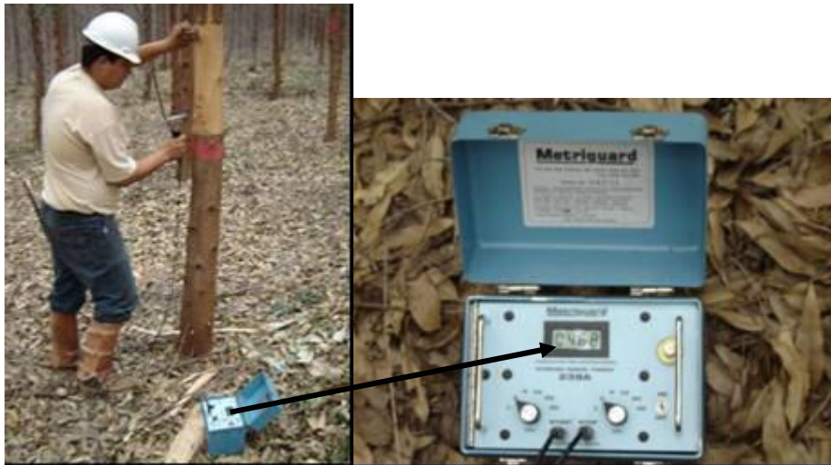
FIGURA 4 Temporizador de ondas de tensão em aplicação na direção transversal e longitudinal na árvore (detalhes do registrador do tempo em microssegundos)
