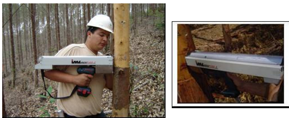
FIGURA 2 Resistógrafo em aplicação para a obtenção de dados de resistência mecânica à penetração de broca na madeira.
