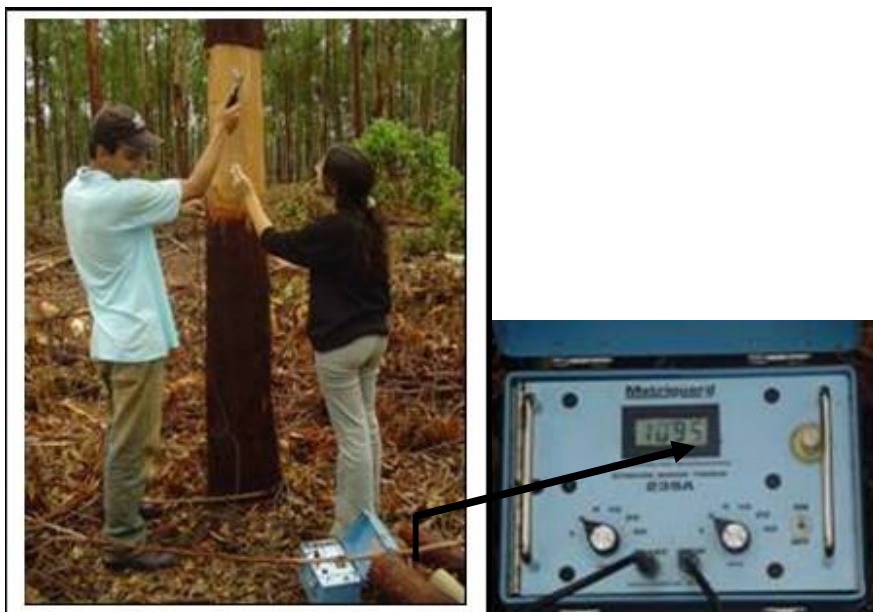
Figura 2 Temporizador de ondas de tensão em aplicação na direção radial e longitudinal na árvore (detalhes do registrador do tempo em microssegundos)
