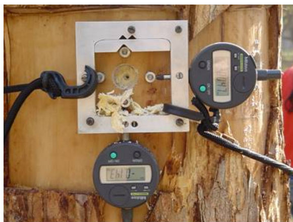
Figura 1 Extensômetro utilizado para a obtenção da deformação residual longitudinal (DRL) e tangencial (DRT) de crescimento na árvore viva
