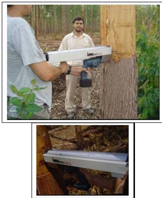
Figura 3 Resistógrafo em aplicação para a obtenção de dados de resistência à penetração de broca na madeira
