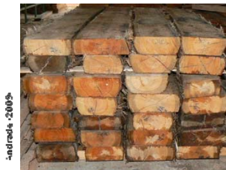
Figura 3 Pranchões de 10 cm de espessura, obtidos com o desdobro em serra de fita dos toretes de 150 cm
