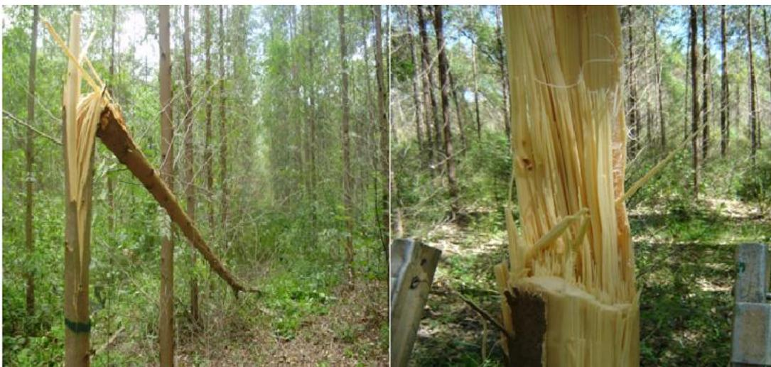
Figura 11. Região de ruptura das árvores durante o teste de resistência à quebra.
