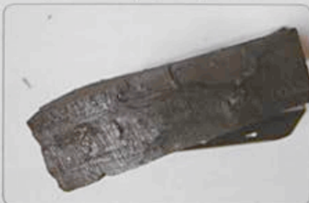
Figura 7 - Corte radial em uma peça de carvão mostrando raios largos encontrados em algumas espécies nativas, porém não encontrados em carvão de eucalipto.
