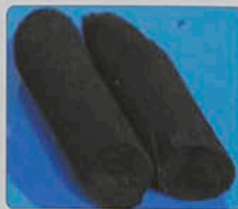
Figura 5 - Medula e casca incompatíveis com carvão produzido com madeira de eucalipto.
