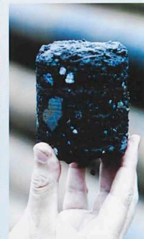
Amostra da camada de 15 centímetros da superfície do pátio da V & M em Barreiro, Belo Horizonte, retirada três semanas após a aplicação do RBI Grade 81 .
