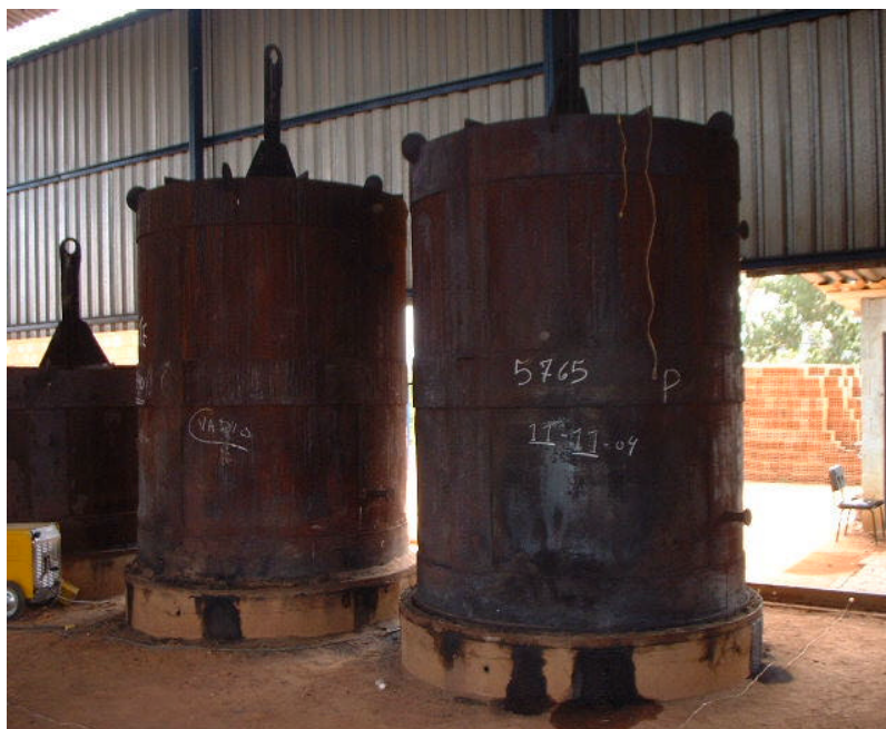
Figura 2 - Forno container na estação de pré-pirólise
