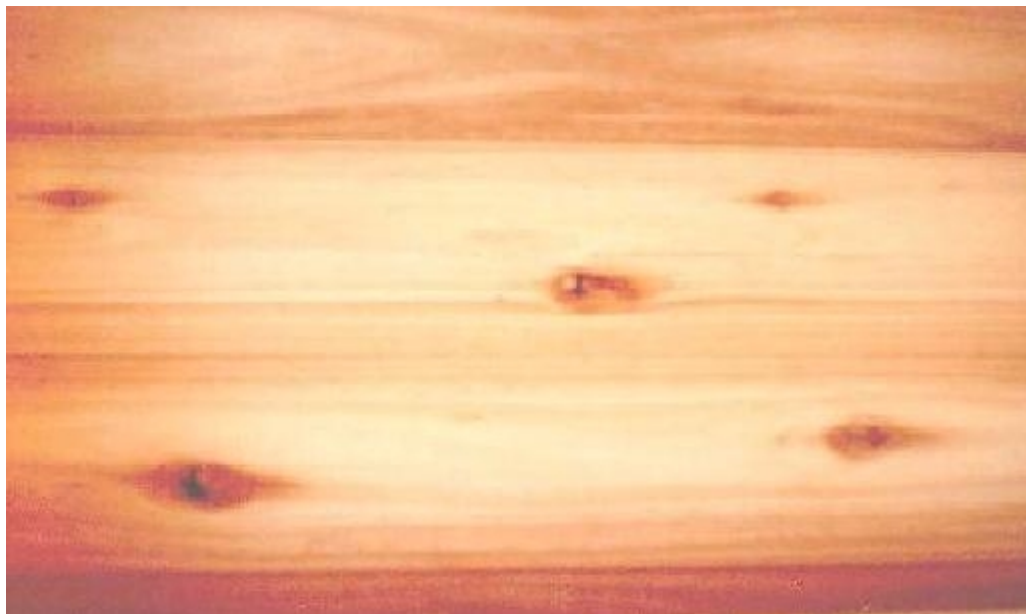
Figura 19 – Nós mortos associados com bolsas de resina, em tábuas de Eucalyptus grandis , na serraria da CAF Santa Bárbara Ltda, em Martinho Campos, MG.
