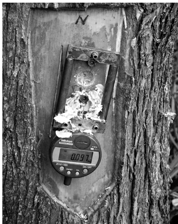
Figura 1. Aparelho do "CIRAD-Forêt - Growth Strain Gauge", usado para a medição da deformação residual longitudinal (DRL).
