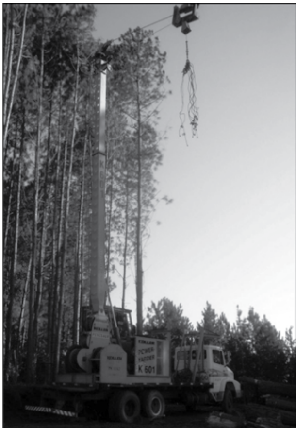
Figura 1. Cabo aéreo montado sobre caminhão. Figure 1. Aerial cable on truck.
