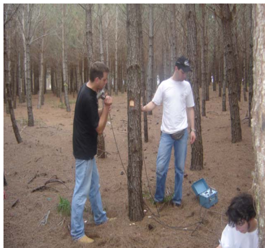
Figura 1. Medição da propagação de ondas de tensão em árvores em pé. Figure 1. Measurements speed of propagation of waves of tension in the trees.
