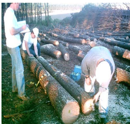
Figura 2. Medição da propagação de ondas de tensão em toras. Figure 2. Measurements speed of propagation of waves of tension in the logs showed.
