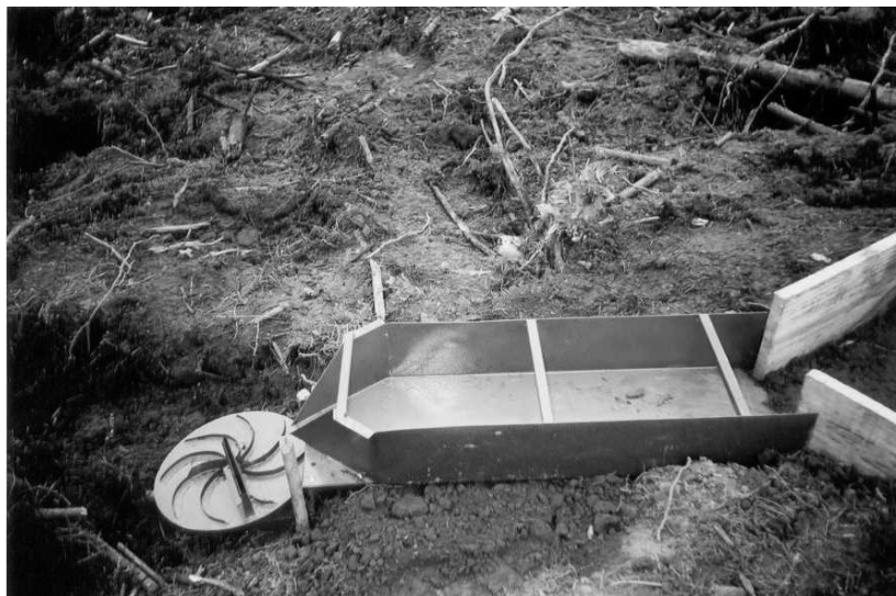
Figura 2. Detalhes da calha coletora de enxurrada Coshocton , no momento da implantação do projeto. Figure 2. Details of Coshocton runoff samplers, in the time of project implantation.
