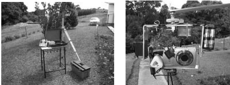
Figura 3. Parte do sistema de mastro estendível (esquerda) e a plataforma e o sistema fotográfico (direita). Fonte: Disperati, 2009.
