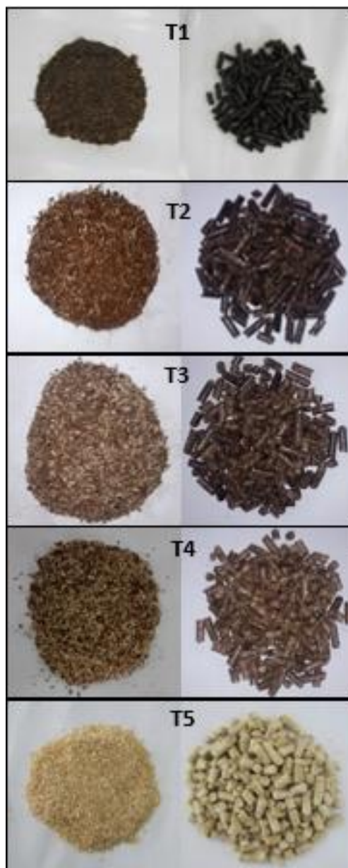
Figura 4 – Pellets produzidos a partir da biomassa do resíduo pós torrefação do café e pinus em diferentes proporções
