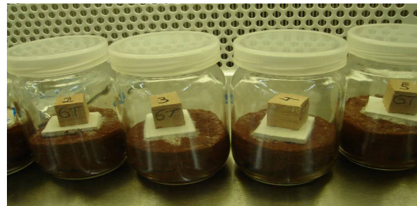
FIGURA 2: Corpos de prova recém-introduzidos nos frascos sobre a placa suporte (Fonte: LPF, 2010).
