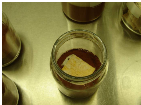
FIGURA 1: Placa suporte após inoculação do micélio do fungo (Fonte: LPF, 2010).
