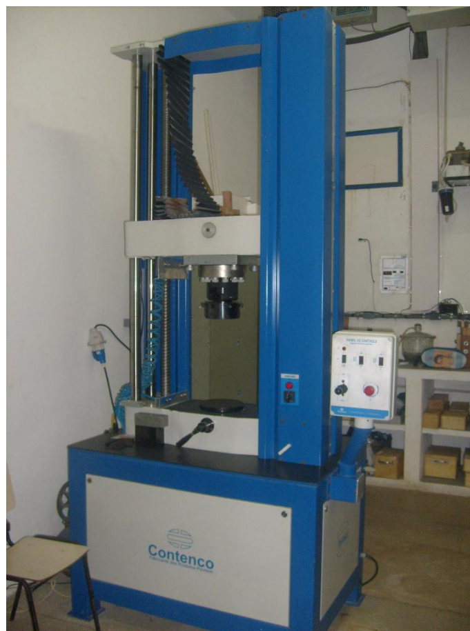
Figura 5. Máquina Universal utilizada nos ensaios de ligações estruturais, Laboratório de Propriedades Mecânicas da Madeira, UFRRJ.
