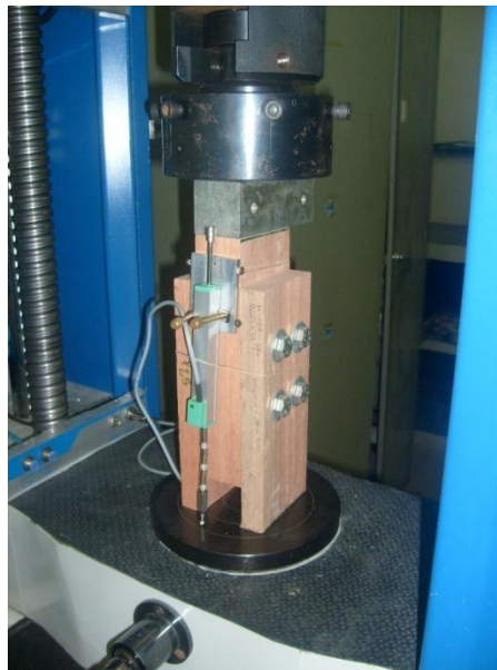
Figura 11. Ensaio da ligação paralela parafusada em E. pellita
