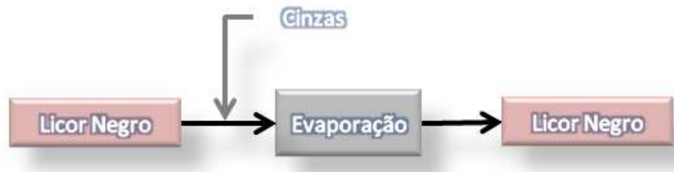
Figura 3.1.4: Diagrama simplificado do método de medição por meio da medição de vazão e concentração na evaporação.
