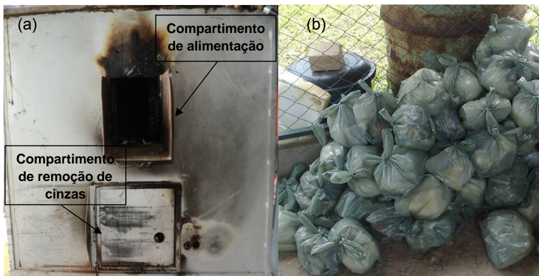
Figura 2.5 – (a) Alimentação de resíduos, compartimento de remoção de cinzas e (b) cargas de 100 g de resíduos.
