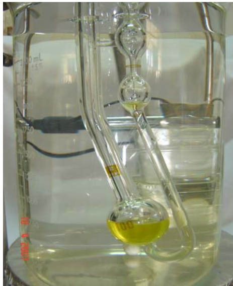
Figura 7- Montagem do aparelho para medida de viscosidade cinemática.
