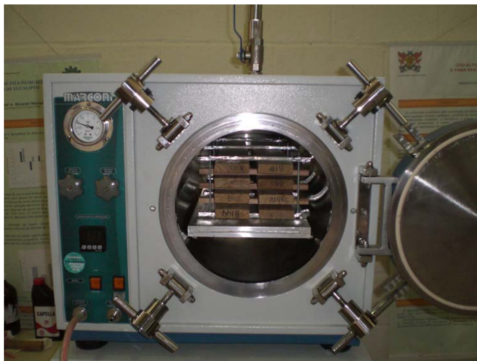
FIGURA 3 – Estufa contendo as amostras a serem termorretificadas.
