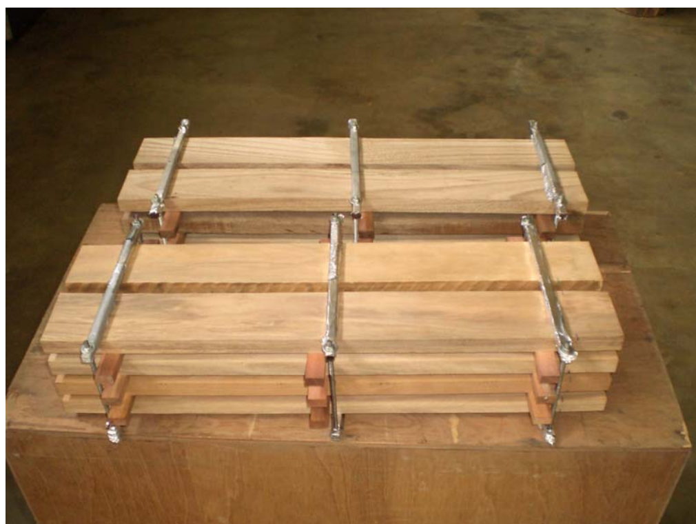
FIGURA 4 - Entablicamento e sistema para fixação das madeiras a serem termorretificadas na estufa.
